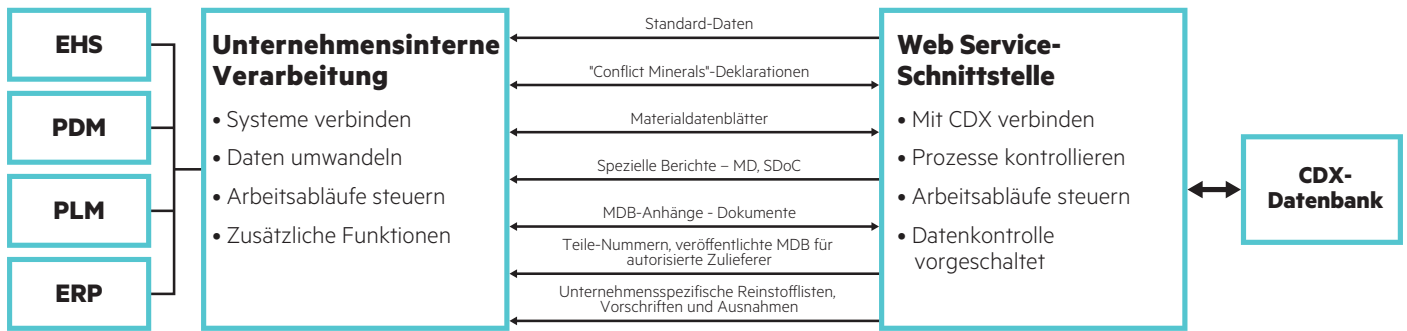
Abbildung 1: Funktionsplan der CDX WSI-Lösung
